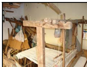
foto 13 – trava, braço e varão do tear
