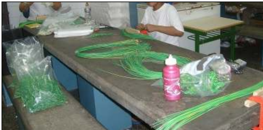
Foto 01. Oficina da E2 no refeitório. Finalização e embalagem de fios para fogão. Por Camilla Marcondes Massaro.
