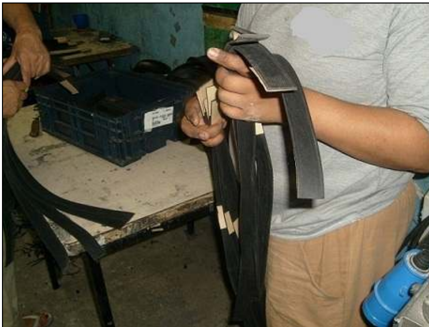
Foto 04. Oficinas da E5 em salas adaptadas – piso inferior. Corte e finalização de peças em borracha. Por Camilla Marcondes Massaro.
