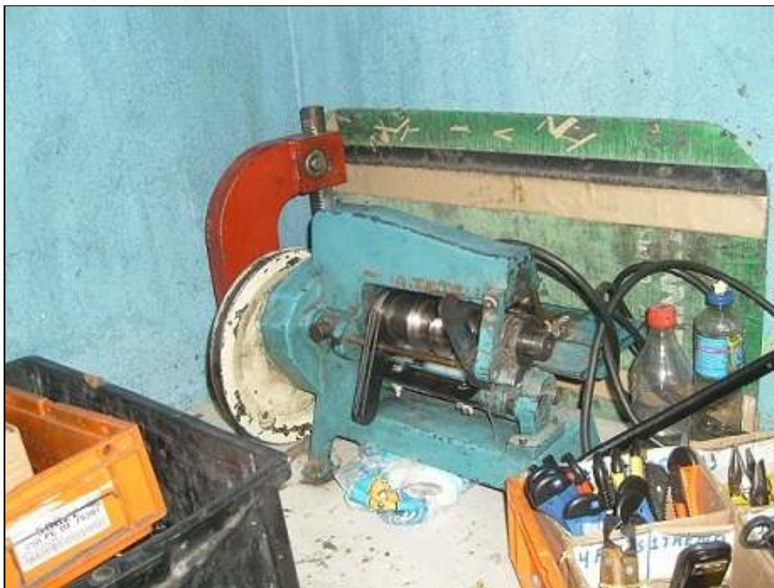
Foto 11. Máquina para corte de peças de borracha da E5. Corte e finalização de peças em borracha. Por Camilla Marcondes Massaro.
