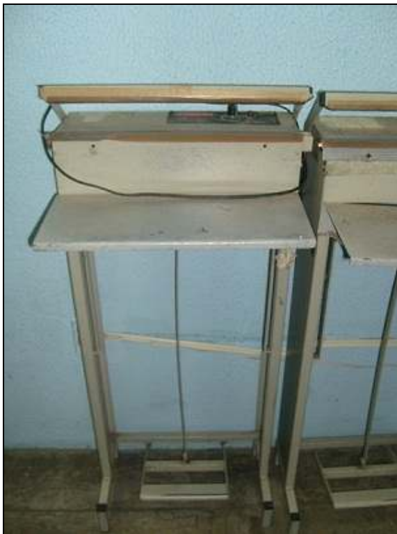
Foto 10. Máquinas seladoras da E1. Embalagem de grelhas (ralos). Por Camilla Marcondes Massaro.
